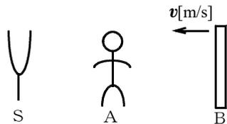
(2) (1) で求めた振動数の音を壁が反射して、観測者Aが聞くと考える。観測者Aが聞く反射音の振動数は、ドップラー効果の式 ( $f' = \frac{V-v'}{V-v}f$ ) より、音が伝わる方向と音源 (この場合は壁) が進む方向は同じなので引いて、
