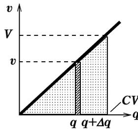
※コンデンサーの電気を蓄えるにした仕事はコンデンサーにエネルギーとして蓄えられる。これを静電エネルギーという。静電エネルギーは ( $Q=CV$ ) を用いて、次のように変形できる。
