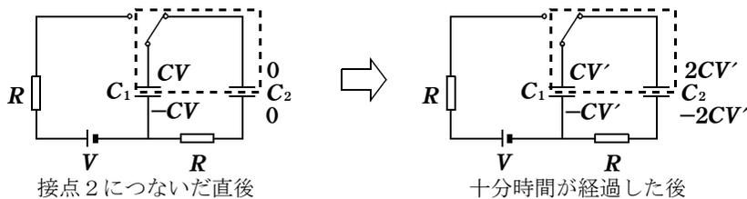
この部分 (コンデンサー  $C_1$  の上極板とコンデンサー  $C_2$  の上極板) は外部との接触がないので、電気量が保存される。これを絶縁部分の電気量保存則という。これより、
