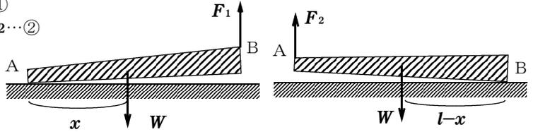
したがって、重さ  $F_1 + F_2$  で点Aから点Bに向かって  $\frac{F_1 l}{F_1 + F_2}$  の場所に重心がある。
