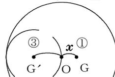
(3) 円板Dの重心も中心にあり、これを円板Cのくり抜かれた部分に入れると、2物体の中心から左にずれた位置  $G''$ に重心がくる。一方、円板Cの重心Gは(2)で求めた通りである。円板Cと円板Dのそれぞれの重心位置と質量より、2物体の重心は線分  $GG''$ を  $2 : 3$ に内分する点にくる。以上より、2物体の重心を中心から左に  $y$ [m]とすると、
