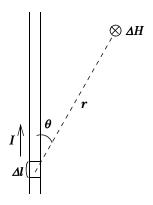
この式を用いて前述の電流が作る磁場の公式を導出していきましょう。まずは、円形電流から考えます。 円形電流はコイルの中心に作る磁場ですので、角度  $\theta$  は  $90^\circ$  になっています。また、電流のいずれの部分も、コイルの中心からは半径 r だけ離れています。これをビオ・サバールの式に代入すると次のようになります。
