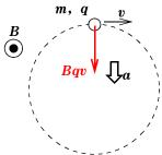
働く力は大きさ Bqv のローレンツ力だけなので、半径をr として円の中心方向について運動方程式を立てると、次のようになります。
