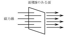
次に、磁気量 m[Wb]のN極から出る磁力線の本数を調べましょう。N極を中心とする半径 r[m]の球面S上では、磁気力のクーロン力( $f=\frac{kmm'}{r^2}$ )定数を k[Nm²/C²]とすると、磁場の強さが( 1 )[N/C]となっています。球面Sの面積が( 2 )[m²]であることから、球面Sを貫く磁力線の総数、つまり、磁気量 m[Wb]のN極から出る磁力線の本数は( 3 )[本]と求まります。
