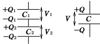
このとき、 $C_1$  の上部と  $C_2$  の下部が合成したコンデンサーの極板部分に相当しています。したがって、合成したコンデンサーが蓄えている電気量を  $Q$  とすると、 $C_1$  と  $C_2$  のコンデンサーが蓄える電気量も  $Q$  となっていることが分かります。 $(Q=CV)$  より、それぞれのコンデンサーにかかっている電圧  $V$  は、
