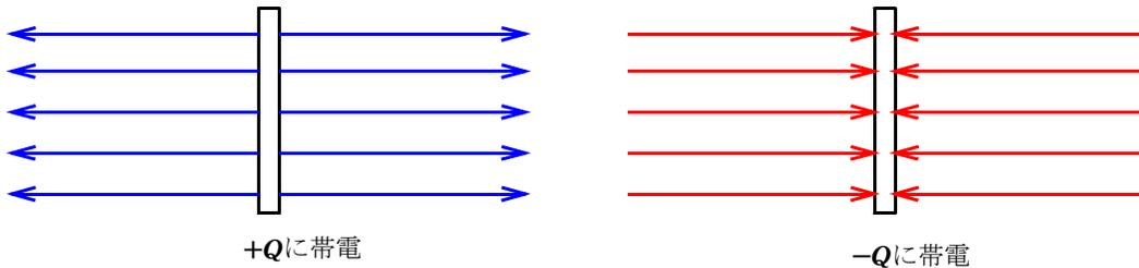
この2つの極板をお互いが向き合うようにして置くと、反対向きの電気力線は打ち消し合い、次のようになります。
