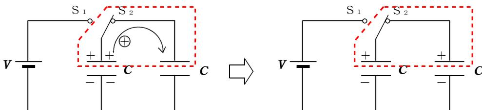
十分に時間が経過すると、両方のコンデンサーの電圧が等しくなります。この電圧を  $V'$  とします。また、右の図で点線で囲んだ部分はスイッチを  $S_2$  につないでからはどことも触れていません。したがって、電気量の合計は変わりません。このように、外部と遮断され電気量の和が保存されているところを絶縁部分と言います。絶縁部分について電気量保存則を立てると次のようになります。
