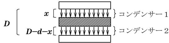
このとき、コンデンサー1とコンデンサー2が直列に繋がれていると考えることができます。コンデンサー1と2の電気容量は  $(C = \frac{\epsilon S}{d})$  より、それぞれ  $\frac{\epsilon_0 S}{x}$ 、 $\frac{\epsilon_0 S}{D-d-x}$  となるので、合成容量  $C'$  は、
