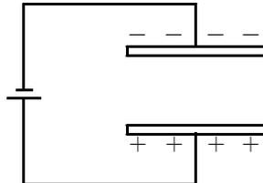
電池の電圧とコンデンサーの電圧が等しくなると、電位の差が無くなり電流が流れなくなります。
