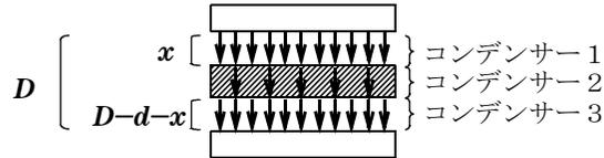
このとき、コンデンサー 1～コンデンサー 3 が直列に繋がれていると考えることができます。コンデンサー 1～3 の電気容量は  $(C = \frac{\epsilon S}{d})$  より、それぞれ  $\frac{\epsilon_0 S}{x}$ ,  $\frac{\epsilon S}{d}$ ,  $\frac{\epsilon_0 S}{D-d-x}$  となる (誘電体の誘電率を  $\epsilon$ ) ので、合成容量  $C'$  は、
