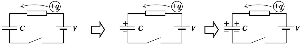
上の図を見てみると、最初はコンデンサーに電気が蓄えられていなかったので簡単に電気が移動します。しかし、中央や右の図のように電気が蓄えられていくと、極板に電気が蓄えられ斥力を受け電気が蓄えられにくくなります。しかし、これに逆らって電気が仕事をしているので電気がどんどん蓄えられていきます。
