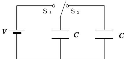
次にスイッチを  $S_2$  につなぎます。このとき、図のように電気が移動します。
