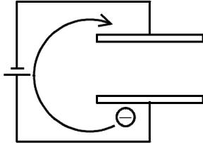
電池の電圧（電位差）によって電場が生じ、金属板内の自由電子が時計回りに移動する。自由電子が移動することで、コンデンサーの上の極板は負に、下の極板は正に帯電する。
