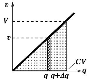
※静電エネルギーは  $(Q=CV)$  を用いて、次のように変形することができます。
