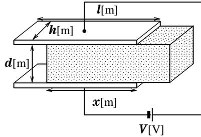
この状態から誘電体をさらに  $\Delta x$  [m]だけゆっくりと挿入します。電池がつながれたままなのでコンデンサーにかかる電圧は  $V$  [V]だと考えると、コンデンサーの静電エネルギーの変化量は次のようになります。
