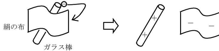
ここで帯電した電気量（単位は[C（クーロン）]）について考えてみましょう。絹の布もガラス棒ももともと帯電していなかったものとしましょう。移動した電子の電気量を  $-q$ [C] とすると、ガラス棒の電気量は（3： ）[C] に、絹の布の電気量は（4： ）[C] になります。注目したのは合計の電気量です。絹の布とガラス棒の合計の電気量が変わらないこと（これを **電気量保存則** と言います）はすぐ理解できるかと思えます。ただ、これを法則として覚えるのではなく、電子のやりとりを物体間でしているだけなので総電気量が変わるはずないと理解して下さい。
