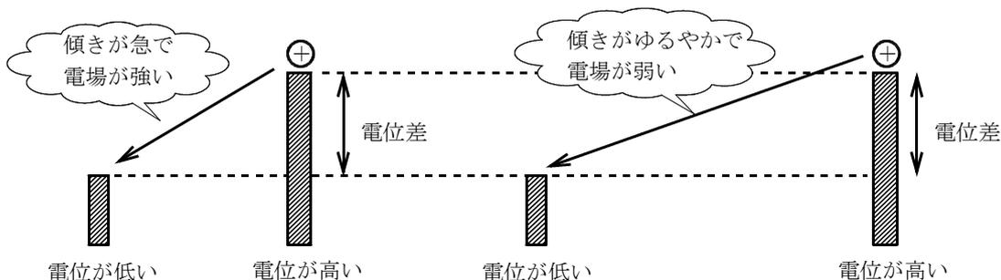
少し難しくなりますが、これより、傾き（縦軸電位，横軸距離）が電場の強さを表していることがわかります。これを式で表すと次のようになります。電位  $V$  が低い方向へ電場が生じているのでマイナスが付いています。
