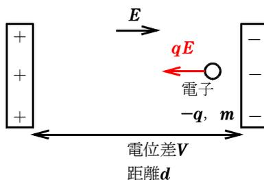
( $f=qE$ ) より、電場から  $qE$ [N]の力を受けています（電場の定義を簡単に導出できる式でした。⑤（電場）を参照して下さい）。運動方程式 ( $ma=f$ ) より、生じる加速度  $a$  は、
