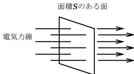
次に、電気量  $+Q$  [C] の正電荷が出る電気力線の本数を調べましょう。正電荷を中心とする半径  $r$  [m] の球面  $S$  上では、クーロン力定数を  $k$  [Nm<sup>2</sup>/C<sup>2</sup>] とすると、電場の強さが ( 1 ) [N/C] となっています。球面  $S$  の面積が ( 2 ) [m<sup>2</sup>] であることから、球面  $S$  を貫く電気力線の総数、つまり、電気量  $+Q$  [C] の正電荷が出る電気力線の本数は ( 3 ) [本] と求まります。誘電率  $\epsilon$  を用いて表すと  $\frac{Q}{\epsilon}$  [本] となります。ただし、 $k$  と  $\epsilon$  は  $4\pi k = \frac{1}{\epsilon}$  の関係があります。
