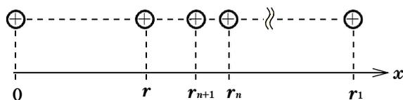
移動させることで電荷間の距離が変わるのでクーロン力の大きさは変化します。ここでは、 $r_n$  から  $r_{n+1}$  までの距離が微小距離と考えるとクーロン力の大きさが  $\frac{kqq'}{r_n r_{n+1}}$  で一定とすると、 $\Delta W$  は、
