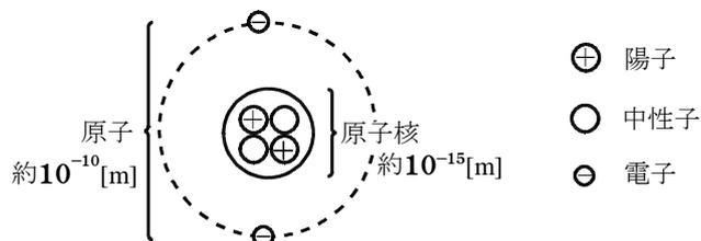
よく見て欲しいのは原子の大きさと原子核の大きさです。原子は原子核の約  $10^5$  倍の大きさになっています。仮に原子核の直径を  $2$  [cm] とすると原子の直径は  $2$  [km] となります。図では描き表せないほどの大きさの違いがあることが分かると思います。原子核はただでさえ小さい原子よりはるかに小さいのです。その狭い領域に陽子が隣接していますが、正の電気同士に生じる斥力よりはるかに大きい核力で結びついています。
