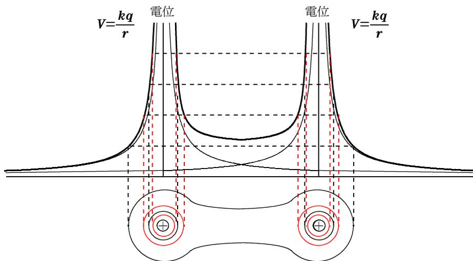
同じ大きさの電気量の正電荷 ( $q[C]$ ) と負電荷 ( $-q[C]$ ) を置いたときの正電荷を結ぶ直線上にそれぞれの点電荷が作る電位は次のグラフのようになります。今回は正負反対の電位になるので、2つの点電荷の垂直二等分線上では合成電位が  $0$  となっています。
