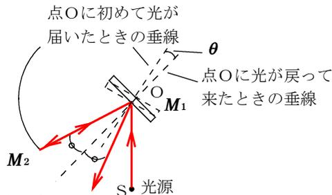
(3) 平面鏡が回転していないと、 $M_2$  から反射された光の入射角は  $M_1$  で反射された時の反射角と等しいので、点Oで反射された光は光源Sへと向かう。いま、平面鏡が角度  $\theta$  だけ回転しているので、 $M_2$  から反射された光の入射角は  $M_1$  で反射された時の反射角より  $\theta$  だけ小さくなる。反射の法則より、点Oで反射されるとき反射角も  $\theta$  だけ小さくなっている。したがって、 $M_2$  から反射した後に  $M_1$  で反射された光は直線OSと角度  $\alpha = 2\theta$  をなしている。
