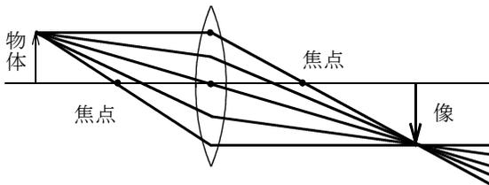
※図のように、物体の頂点から出た全て光は像の頂点に集まるので鮮明な像ができる。したがって、レンズの上半分を通る光が遮られても、下半分を通った光で結像できる。
