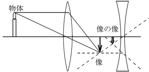
**25** 凸レンズを通った光が結像する位置が下図のように凹レンズの奥にある時は、結像できない。ここで凹レンズがないときにできる像を未完の像と呼ぶ。この位置に光が集まることから、凹レンズの中心を通る光と光軸に平行な光を描き加えた。この光のうち、凹レンズの中心を通る光はそのまま直進するが、光軸に平行な光は手前側の焦点から出た光と同じ道筋を辿るので、下図に実線の矢印として描き加えた。これより、像の位置が分かる。下図より、像を物体、未完の像を像とした、凹レンズの問題と変わりはないので、解答のような方法が可能となる。
