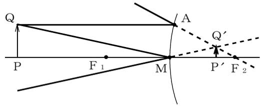
(14) 反射の法則および対頂角の関係から,  $\angle PMQ = \angle P'MQ'$ , また,  $\angle QPM = \angle Q'P'M = 90^\circ$  より, 三角形の2角が等しいことから,  $\triangle PQM$ と $\triangle P'Q'M$ が相似の関係にあることが分かる。
