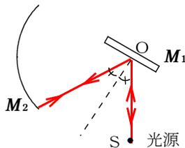
※反射の法則より、入射角と反射角が等しくなる。
